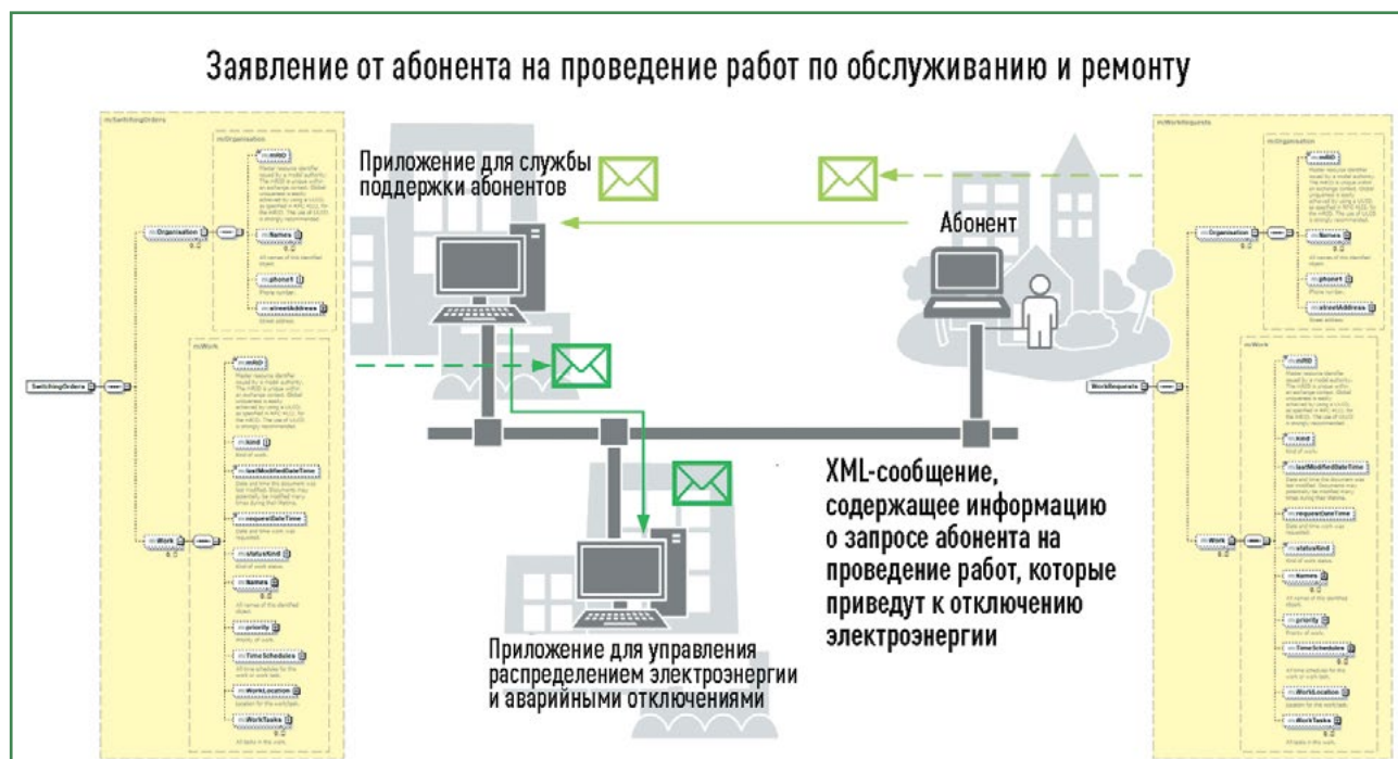
Рисунок 1. Организация унифицированного информационного обмена между программными обеспечениями, используемыми при реализации бизнес-процессов предприятия
